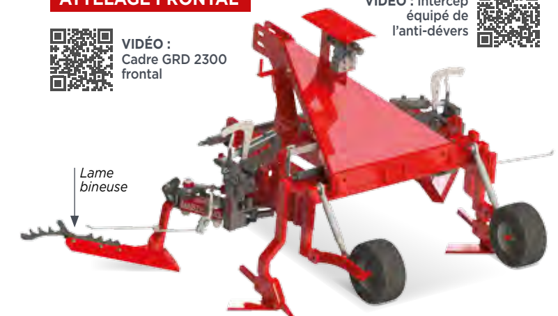
Option REH indépendant droit et gauche intercep GRD commande électrique
