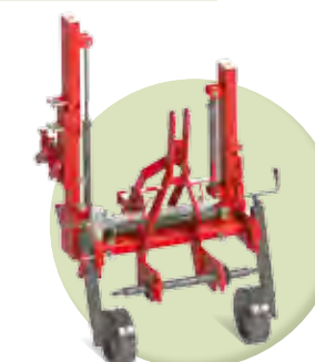
Option REH indépendant droit et gauche intercep GRD commande électrique
